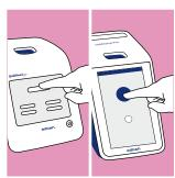
Fermer hermétiquement la cuvette avec le bouchon du réactif Strep A. Ne pas appuyer sur la partie intérieure rose du bouchon de réactif. Procéder au test dans les <u>4 heures</u>. Sélectionner <u>Mesure</u> / <u>Mesure de l'échantillon</u> sur l'écran de l'instrument QuikRead go.
