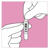
Paire tourner l'écouvillon dans la solution pendant 30 sec. Laisser reposer la solution pendant 1,5 minutes supplémentaires, mais pas plus de 15 minutes au total. Retirer l'opercule en aluminium de la cuvette. Ne pas toucher les surfaces planes transparentes au bas de la cuvette.
