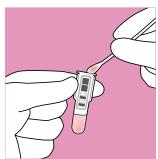
Incliner le tube d'extraction et faire glisser l'écouvillon contre la paroi interne pour transférer la solution à l'aide de l'écouvillon dans la cuvette. S'il reste un grand volume de liquide dans le tube, verser le liquide restant dans la cuvette. Remuer vigoureusement à l'aide de l'écouvillon, la solution vire au rouge. Essorer l'écouvillon contre la paroi intérieure avant retrait.
