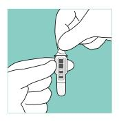
Retirer l'opercule en aluminium de la cuvette.
