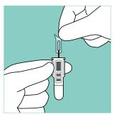
Insérer le collecteur d'échantillon dans la cuvette dans un délai de 2 minutes.
