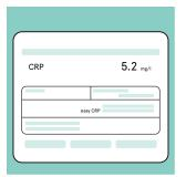
Le résultat s'affiche à l'écran et la cuvette ressort automatiquement lorsque la mesure est terminée.
