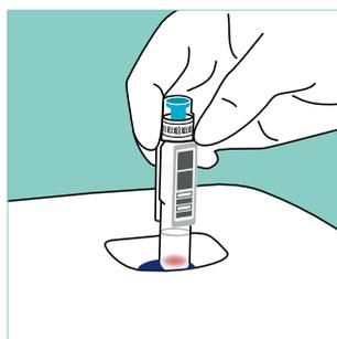
**5** Sélectionner Mesure / Mesure de l'échantillon sur l'écran de l'instrument QuikRead go. Insérer la cuvette dans le puits de mesure de l'instrument, le code-barres vous faisant face.
