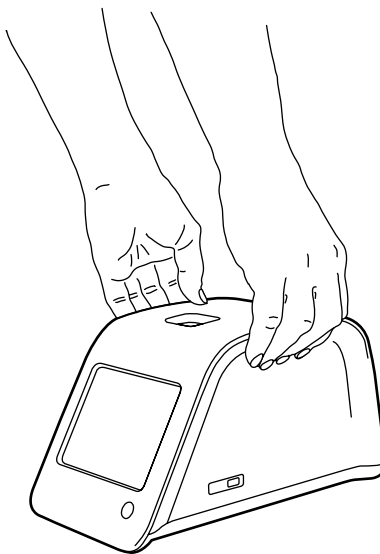
Image 5 Soulever l'appareil avec deux mains.
