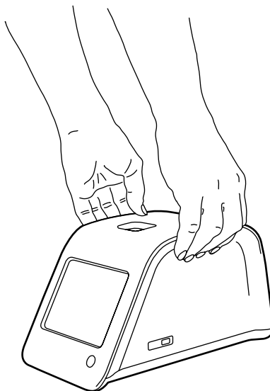
Bilde 5 Løfte instrumentet med to hender.
